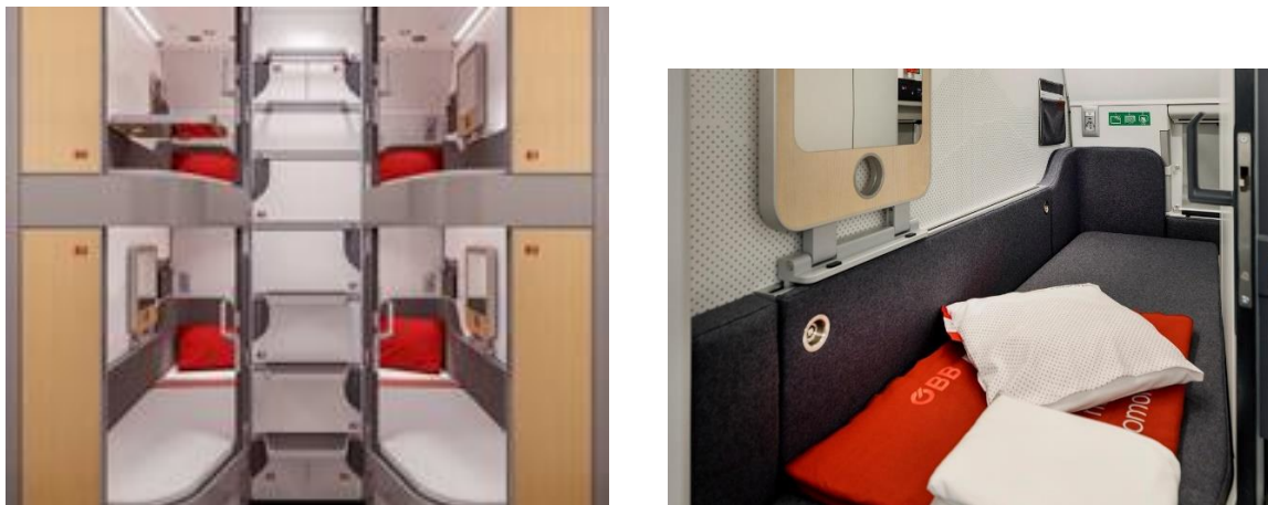
Figur 12. Mini-kabiner, på vänstra bilden grupperade fyra tillsammans i två våningar. Bilder: ÖBB.
