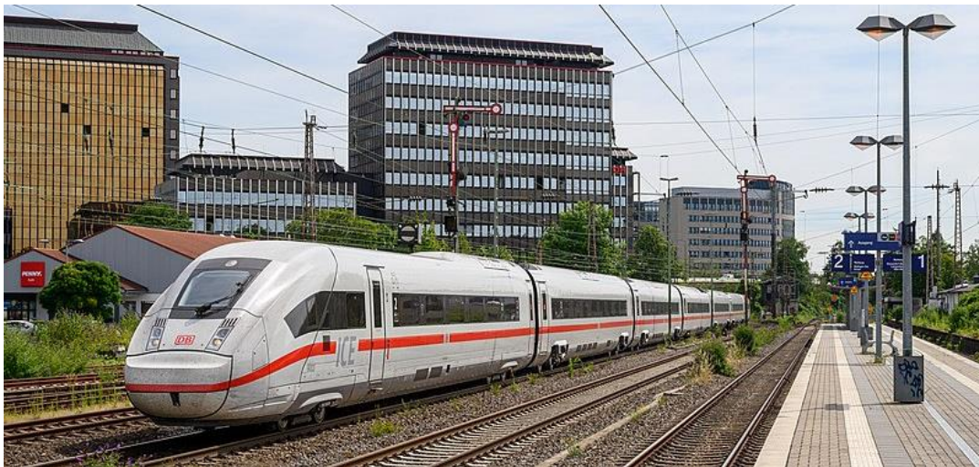
Figur 4. DB ICE 4. Längd mellanvagn 28,75 m. Bild från Düsseldorf Rath DB 9003.
