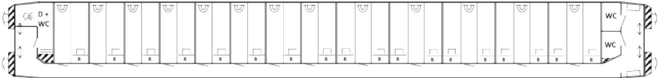
Figur 9. Vagnstyp B, variant B1, med hög platskapacitet. (B=bagage, D=dusch)
